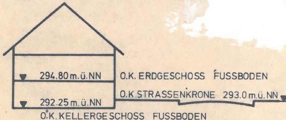
**Bauausführung:** Das Untergeschoß (Kellergeschoß) ist aus Baustoffen herzustellen, die bei Überschwemmung nicht wesentlich beschädigt werden. Die Installation für Strom, Gas, Öl, Wasser und Abwasser ist so auszuführen, daß bei Hochwasser keine erheblichen Gefahren für Menschen oder die Umwelt entstehen. Öltanks sind gegen Auftrieb zu sichern.
